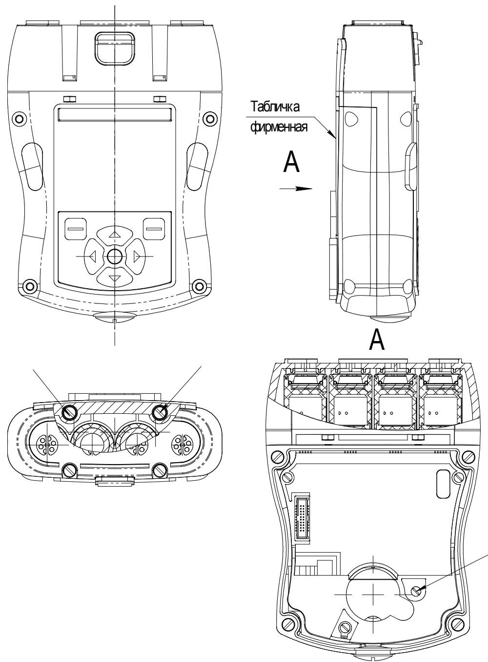
Стрелками указаны места пломбировки от несанкционированного доступа и обозначение мест для нанесения оттисков клейм.
