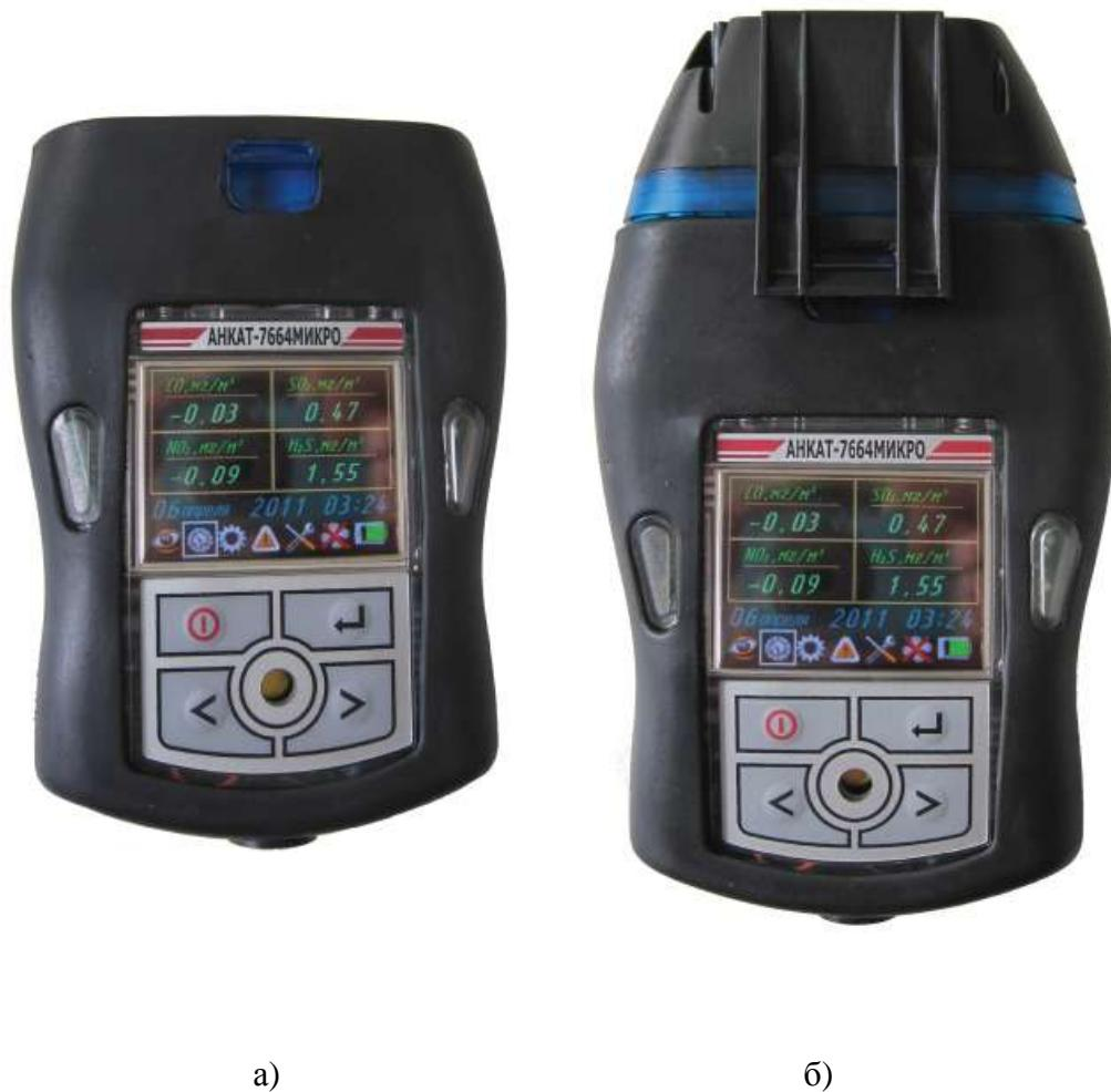
Рисунок 1 - Внешний вид газоанализатора:
