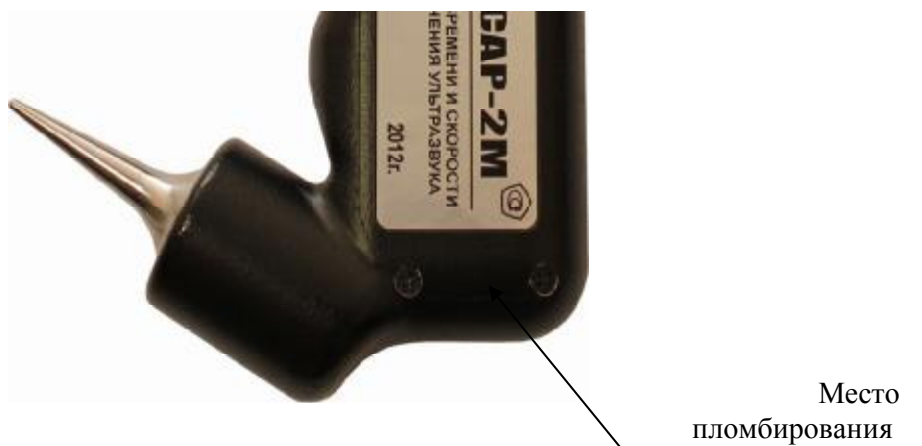
Рисунок 2 – Место пломбирования и клеймения на приборе модификации ПУЛЬСАР-2М
