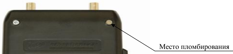
Рисунок 1 - Место пломбирования и клеймения на приборах модификации ПУЛЬСАР-2.1, ПУЛЬСАР-2.2
