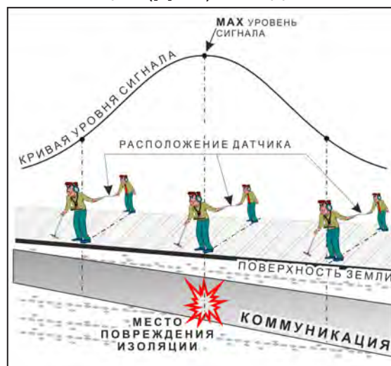
применение датчика-определителя дефектов коммуникации (ДОДК) методом max
