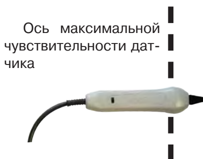
Выбор кабеля по максимальному сигналу
