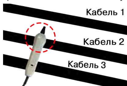
Выбор кабеля по максимальному сигналу
