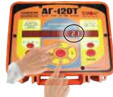
8. Установить трассировочный «ток» в коммуникации
