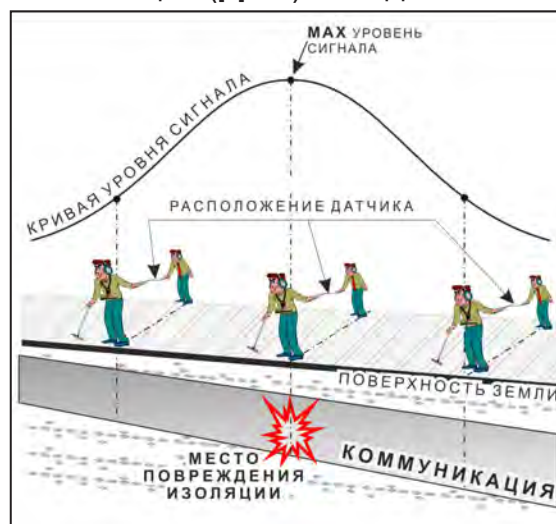
применение датчика-определителя дефектов коммуникации (ДОДК) методом min
