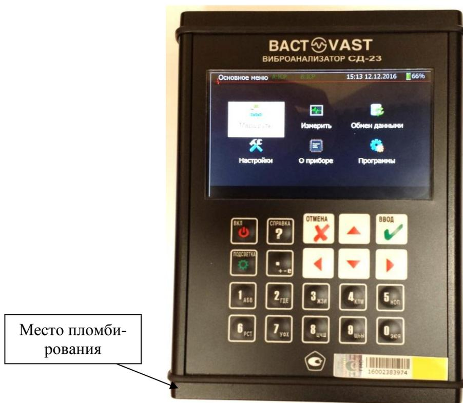
Рисунок 1 - Общий вид и место пломбирования СД-23
