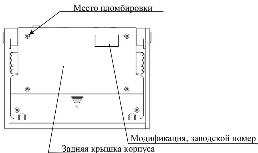
Рисунок 3 - Схема пломбировки корпуса дефектоскопа
