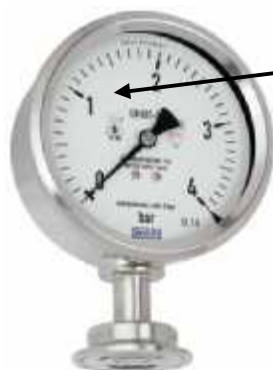
Рисунок 5 - Место нанесения знака поверки манометров
