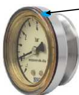
Рисунок 4 - Пример пломбирования манометров
