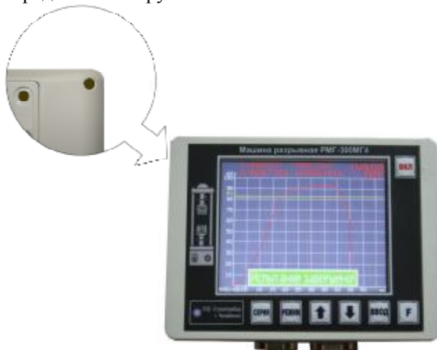
Рис. 1 – Схема пломбирования от несанкционированного доступа
