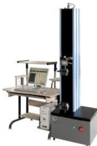
Рисунок 1. Общий вид машины испытательной универсальной РЭМ, выпускаемой в одноколонном исполнении.
