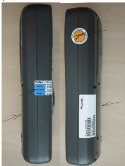
Рисунок 2 - Места пломбирования от несанкционированного доступа, показаны стрелками на боковых сторонах, на нижней поверхности мультиметра стрелкой показано место нанесения знака утверждения типа.
