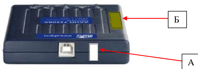
Рисунок 2 – Схема пломбировки от несанкционированного доступа (А) и нанесения знака поверки (Б)
