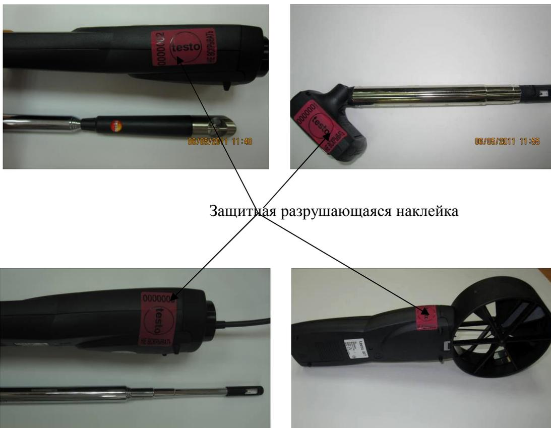
Защитная разрушающаяся наклейка
