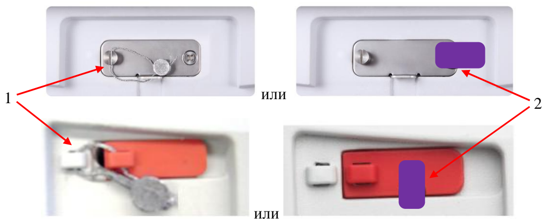
Рисунок 2 - Схема пломбировки от несанкционированного доступа, обозначение места нанесения знака поверки (1 - свинцовая или пластиковая пломба со знаком поверки в виде отиска поверительного клейма; 2 - пломба, знак поверки в виде разрушаемой наклейки)
