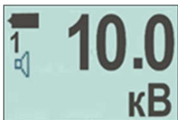
Рисунок 2.6 – Отображение звуковой сигнализации на дисплее
