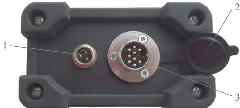
*1 – разъем для подключения зарядного устройства; 2 – крышка для защиты разъема подключения высоковольтного трансформатора-держателя; 3 – разъем для подключения высоковольтного трансформатора-держателя.*
