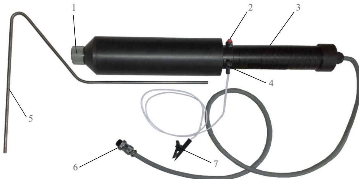
*1 – зажим для подключения электрода; 2 – кнопка подачи напряжения на электрод; 3 – рукоятка держателя; 4 – клемма подключения провода заземления; 5 – Т-образный электрод; 6 – штекер подключения к блоку контроля и управления; 7 – зажим типа «крокодил».*
