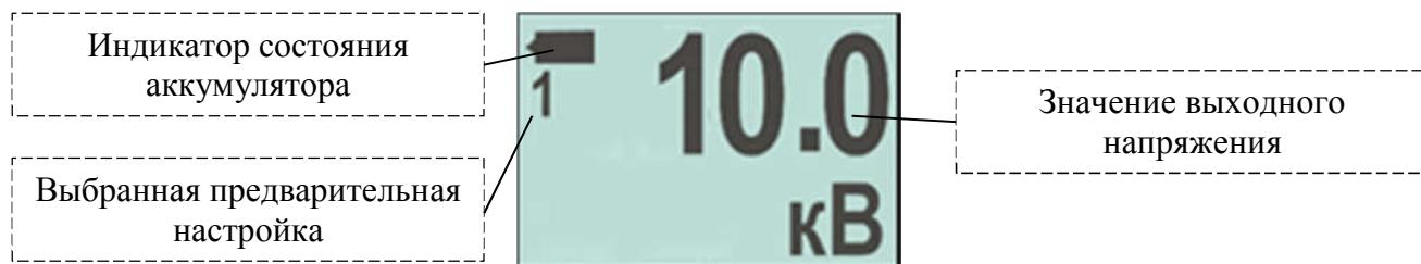
Рисунок 2.3 – Дисплей прибора в рабочем режиме
