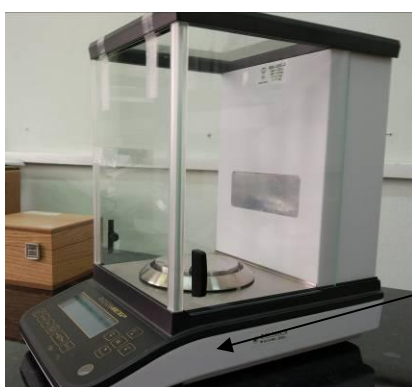
Рисунок 3 – Обозначение места нанесения знака поверки весов
