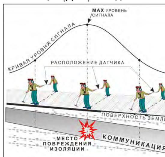
применение датчика-определителя дефектов коммуникации (ДОДК) методом max
